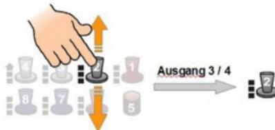
Sie befinden sich im Konfigurationsmodus für Schalterpositionen. Die rote LED leuchtet wieder konstant nachdem Ausgangspaar 1 und 2 zuvor zugeordnet wurde. Bewegen Sie nun den Schalter 2 in eine beliebige Richtung und lassen ihn dort so lange, bis die rote LED kurz ausgeht. Der Schalter wurde zugeordnet. Die Ausgänge 3 und 4 sind nun dem Schalter
