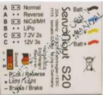
Das Typenschild ist gleichzeitig auch Kühlkörper. Der S20 wird im Betrieb warm (besonders bei 12V) und braucht ggf. etwas Kühlung, deshalb für Belüftung sorgen und nicht mit Schaumstoff o.ä. Umwickeln!
