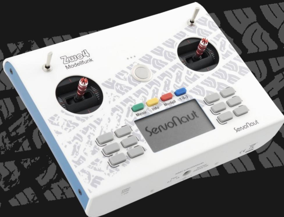
2,4 GHz Funksystem • 12 / 16 Kanäle • Multifunktionstasten • Maximale Kompatibilität
