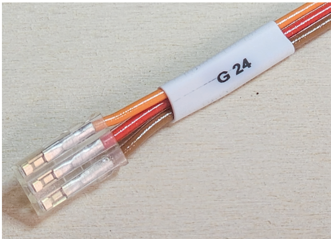
Eigentlich nur eine Kleinigkeit, aber sehr sinnvoll. Gerade in Funktionsmodellen helfen die kleinen Label am Servokabel die Übersicht zu behalten
