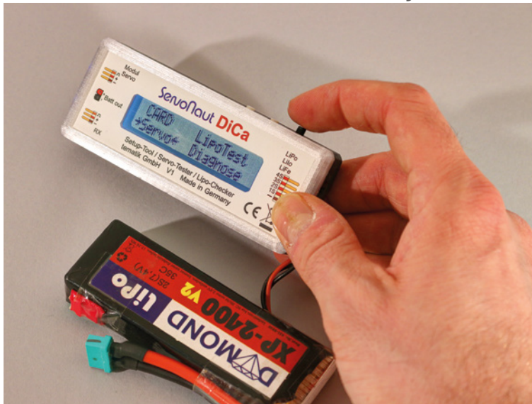
Lipo-Tester: Gesamt- und Zellenspannung sowie grafische Ladeanzeige lassen den Ladezustand auf einen Blick erkennen
