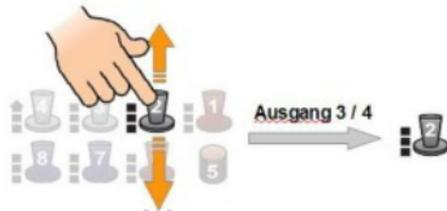
Sie befinden sich im Konfigurationsmodus für Schalterpositionen. Die rote LED leuchtet wieder konstant nachdem Ausgangspaar **a(1)** zuvor zugeordnet wurde. Bewegen Sie nun den Geber 2 in eine beliebige Richtung und lassen ihn dort so lange, bis die rote LED kurz ausgeht. Der Schalter wurde zugeordnet. Die Ausgänge **b(2)** sind nun dem Geber 2 zugeordnet. Die rote LED leuchtet wieder konstant.
