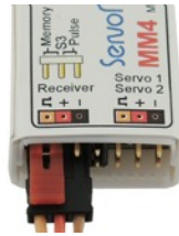
Position Memory (links) Ausgang S3 als Schalter
