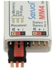
Position Pulse (rechts) Ausgang S3 als Taster
