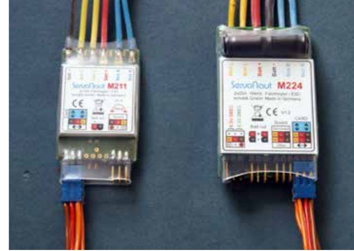
Servonaut M211 und M224 unterscheiden sich in erster Linie in ihrer Baugröße und der Leistung der Reglerausgänge; die Funktionen sind identisch
