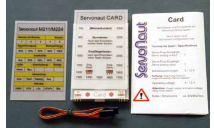
Der Servotester CARD ist als Servo- und Empfängertester sowie als Einstellhilfe für alle kompatiblen Servonaut-Produkte ein überaus praktisches Hilfsmittel
