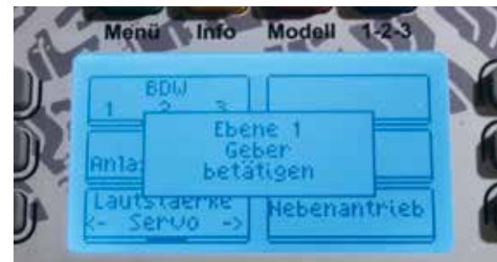
Die Zuordnung der Geber am Sender zu den Ausgängen am Empfänger geschieht beim HS komfortabel über das Menü im Klartext
