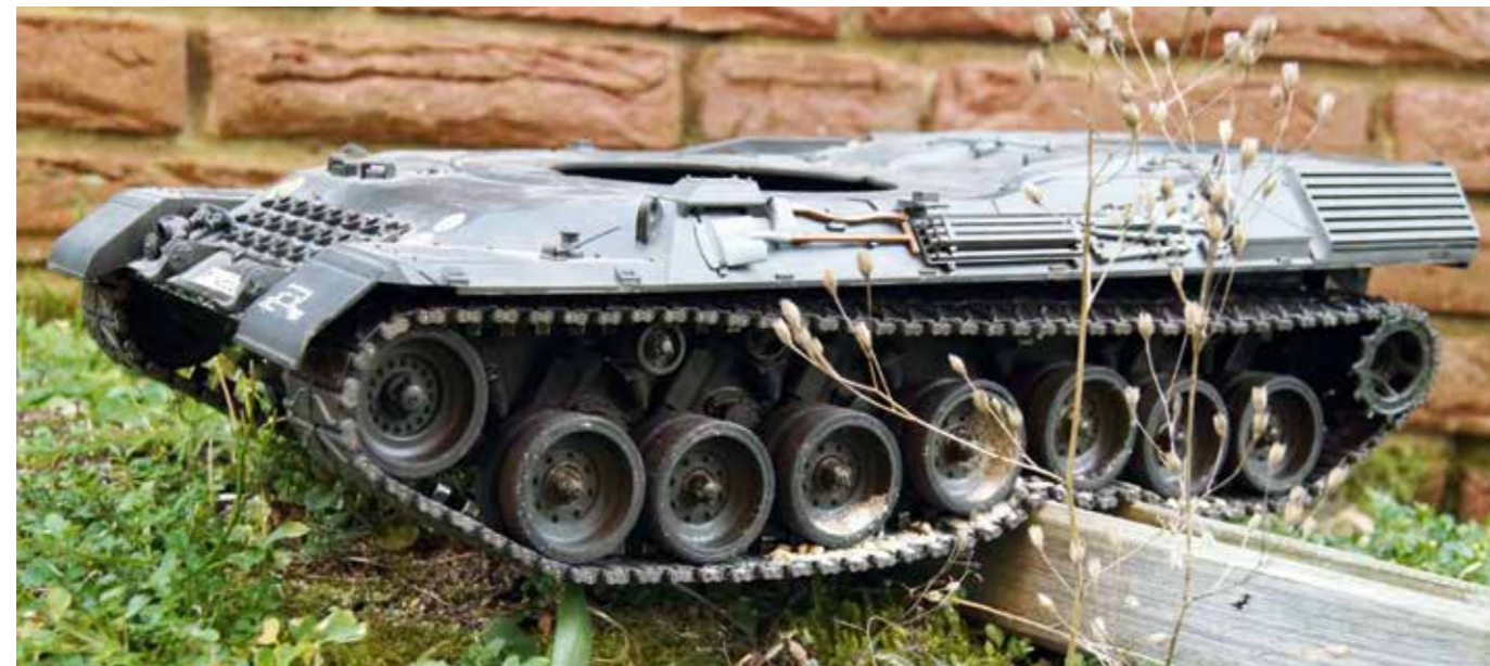
Um den Leo auf dem Balken in Waage zu bringen und zu halten, muss der Regler sehr feinfühlig arbeiten
