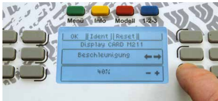
Im DisplayCARD-Menü kann man die Parameter durch Tastendruck anwählen und ändern; auch hier wird nach 10 Sekunden der gewählte Wert übernommen
