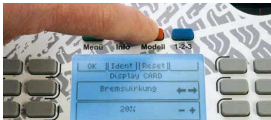
Durch Drücken der roten „Reset“-Taste wird der Wert auf Werkseinstellung zurückgesetzt
