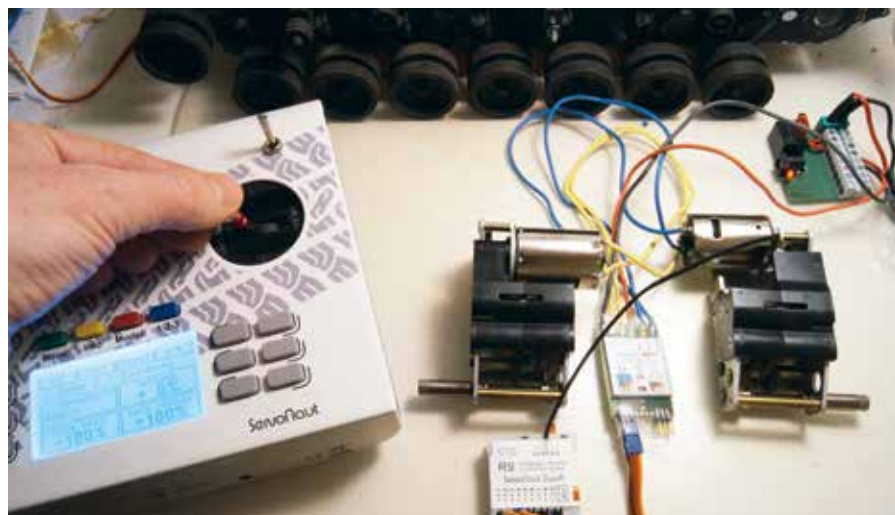
Der erste provisorische Testaufbau noch außerhalb des Fahrzeugs; gleich wurde festgestellt, dass beim Lenken die Motoren gleichsinnig laufen, da einer verpolt war
