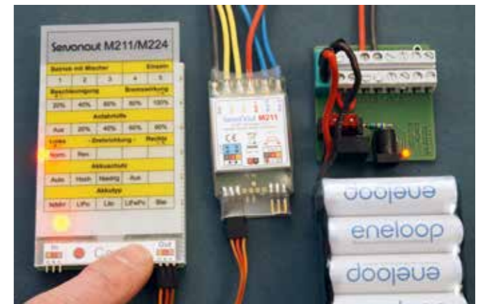
Durch kurzes Drücken der beiden roten Taster navigiert man sich durch die Matrix, langes Drücken verändert den Wert, 10 Sekunden nach Verlassen wird automatisch gespeichert
