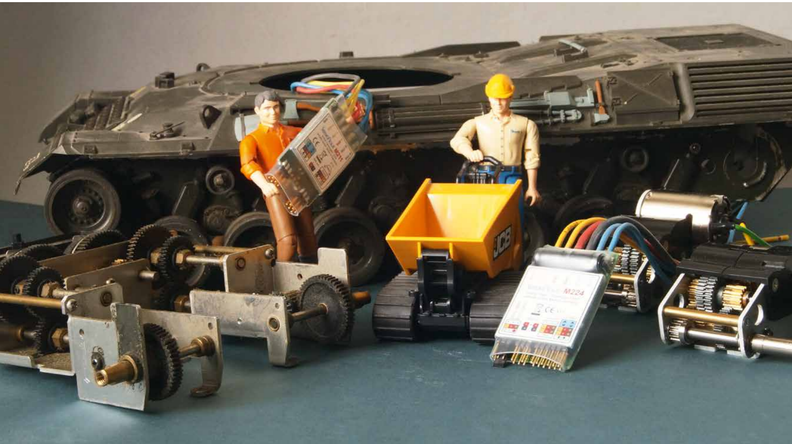
Servonaut M211 und M224 unterscheiden sich in erster Linie in ihrer Baugröße und der Leistung der Reglerausgänge; die Funktionen sind identisch
