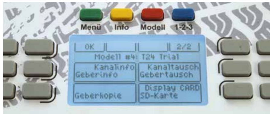
Der Handsender bietet mit dem Menüpunkt „DisplayCARD“ die komfortable Einstellung im Klartext über das Display des Senders
