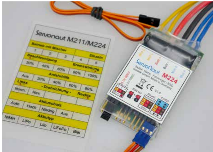
Für Modelle mit zwei Bürstenmotor-Antrieben wie beispielsweise Pistenraupen bietet sich der bis 2 x 20 Ampere belastbare M224 an. Einen ausführlichen Testbericht lesen Sie in dieser Ausgabe von RAD & KETTE
