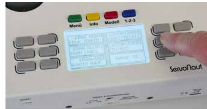
Die Steuerung von Funktionen bei der HS16 erfolgt über die grauen Taster, „Geber“ genannt
