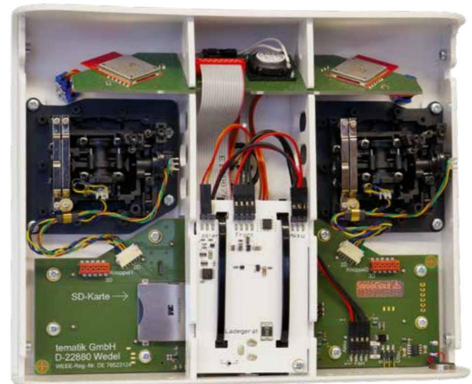
Oben erkennbar sind die beiden versetzt angeordneten Antennen. Unten befindet sich der SD-Kartenslot
