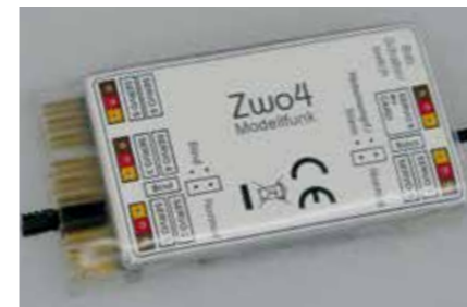
Neun Empfängerausgänge bietet der Zwo4RX9, nutzen lassen sich aber viel mehr Funktionen
