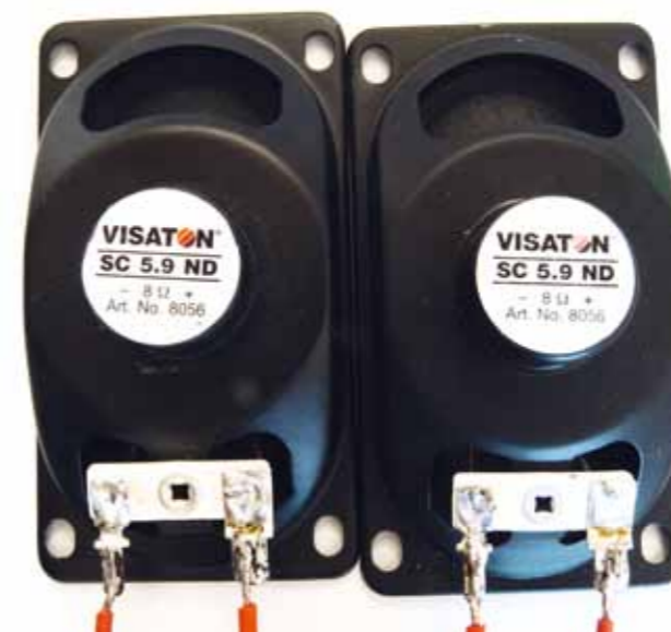
Das SMB verlangt bei 12 Volt Betriebsspannung nach Lautsprechern mit 16 Ohm; man kann dazu zwei gleiche 8-Ohm-Typen in Reihe schalten
