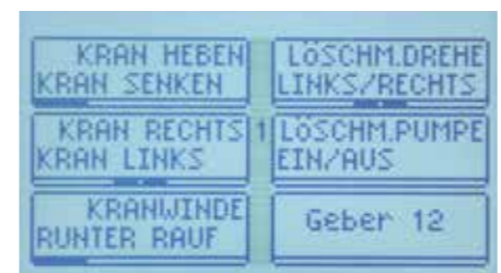
In dieser Geberübersicht eines Beispielmodells ist auf Ebene 1 und 2 eine Reihe von Funktionen übersichtlich angelegt. Die Doppelbelegung erweitert den Funktionsumfang
