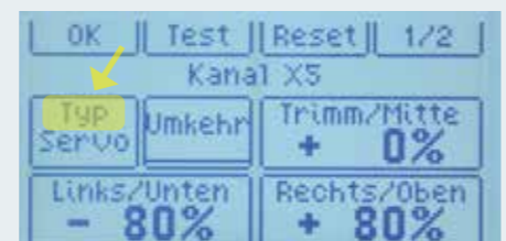
3) Im Servo-Menü lassen sich Standardeingaben, beispielsweise Umkehr oder Wegbegrenzung ändern sowie der Servotyp festlegen
