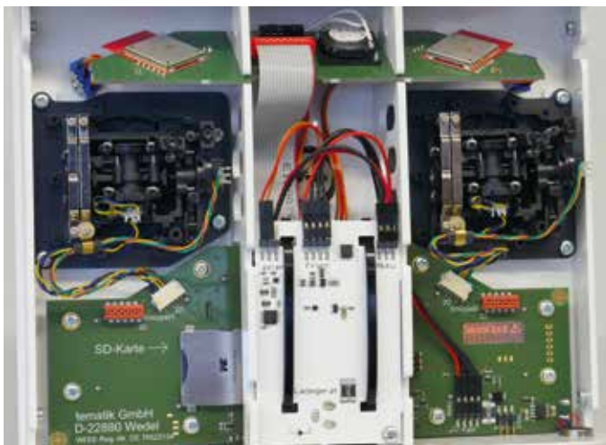
Oben erkennbar sind die beiden versetzt angeordneten Antennen. Unten befindet sich der SD-Kartenslot
