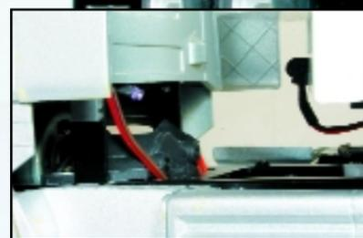
*Montage von Sendediode und Infrarotempfänger erfolgte einfach durch Ankleben. Die breite Streucharakteristik ermöglicht einen guten Empfang*
