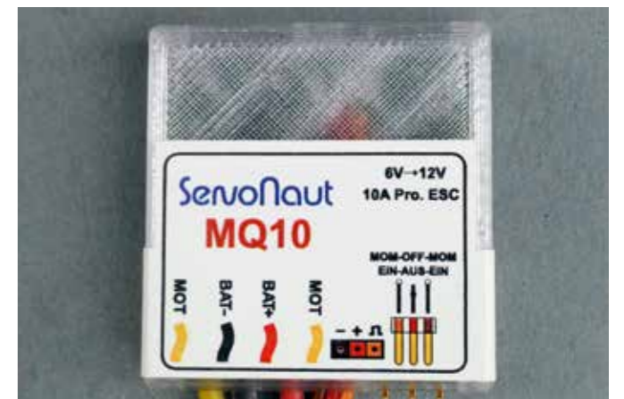
Der MQ10 lässt sich auch ohne Fernsteuerung über einen mechanischen Schalter betätigen. Der Anschluss dazu ist rechts unten zu erkennen und erfolgt über ein Servokabel. Im ScaleART-Unimog kommt aus Platzgründen der Fahrregler MFX – funktionsgleich mit dem MQX – zum Einsatz. Den Anlaufschutz übernimmt in diesem Fall die Programmierung der Commander-Fernsteuerung
