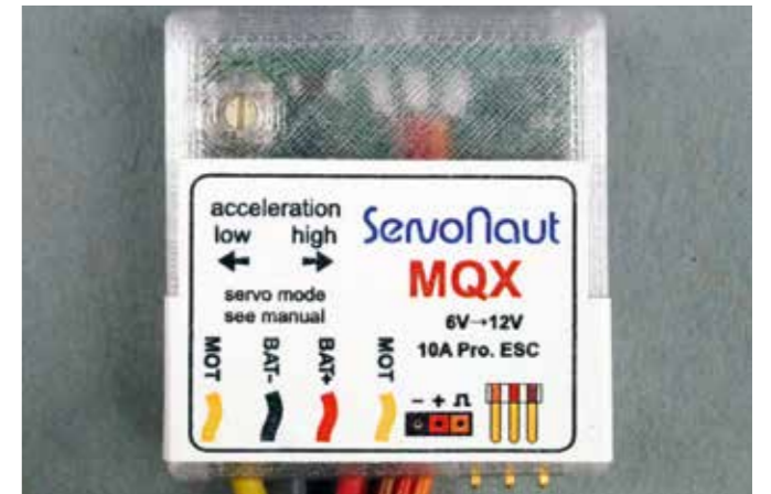
Mit dem Trimmer links oben lassen sich beim MQX das Verhalten der Regelung im Servo- und beim Motorbetrieb einstellen. Unten rechts sieht man die Steckerleiste für das Poti beziehungsweise die Endlagenschalter
