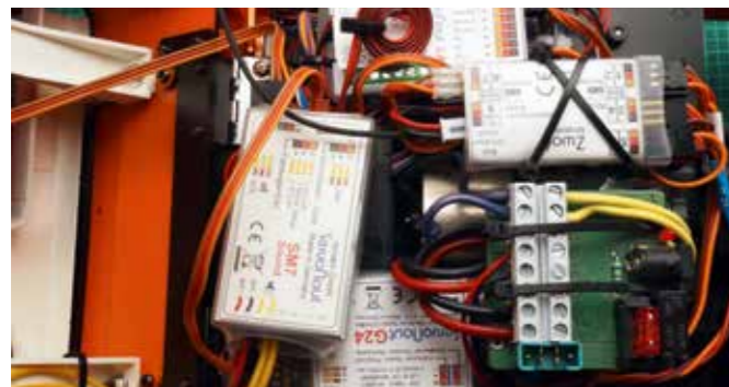
Von unten im Uhrzeigersinn: Fahrregler G24, Soundmodul SM7, Lichtanlage LA10, Empfänger RX9 und Stromverteilerplatine Scaleart mit Schaltrelais und Sicherung
