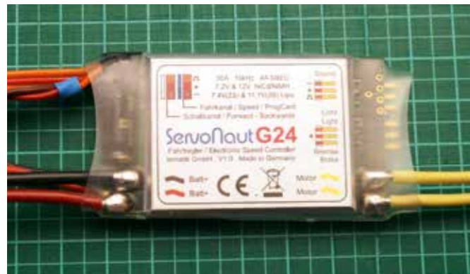
Der Servonaut G24 simuliert ein automatisches Vierganggetriebe und lässt sich im Tempomatbetrieb auf Standard-Fahrregler umschalten
