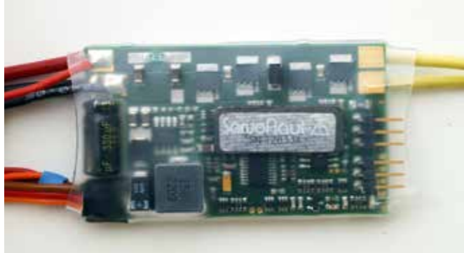
Blick auf das G24-Modul von hinten; den Servonaut-Schriftzug als Hologramm erkennt man nur unter bestimmten Blickwinkeln, was die Produktpiraterie erschweren soll
