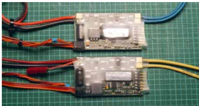
G22 (oben) und G24 im direkten Vergleich; der durchsichtige Schrumpfschlauch lässt erkennen, dass es deutliche Änderungen an Layout und Komponenten gab
