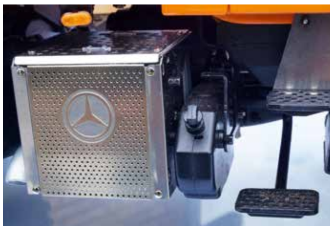
Im Auspufftopf verbirgt sich der Lautsprecher für das Soundmodul; trotz der geringen Größe klingt der Sound eindrucksvoll
