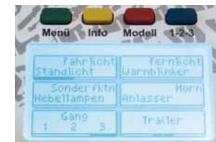
Es lassen sich beispielsweise Dreistufen-Schalter programmieren, mit denen man ein Dreiganggetriebe ansteuern kann
