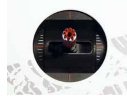
Eines der beiden Knüppelaggregate mit den eleganten, rot eloxierten Knüppeln: die fast schon unangenehm scharfe Spitze lässt sich auch umgedreht montieren und schont dann die Daumenspitzen
