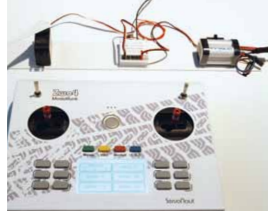
Der einfache, aber praktische Versuchsaufbau für erste Programmierexperimente; so sieht man ohne Gefahr und Umwege sofort die Resultate
