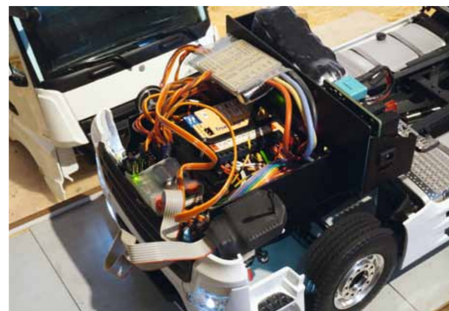
Im Truck sind eigentlich keine Umbauarbeiten nötig, da die eigentliche Arbeit im Sender stattfindet. Man sieht den Zwo4-Empfänger der ersten Serie, den Servonaut S20 und das Truck Light Board von ScaleART
