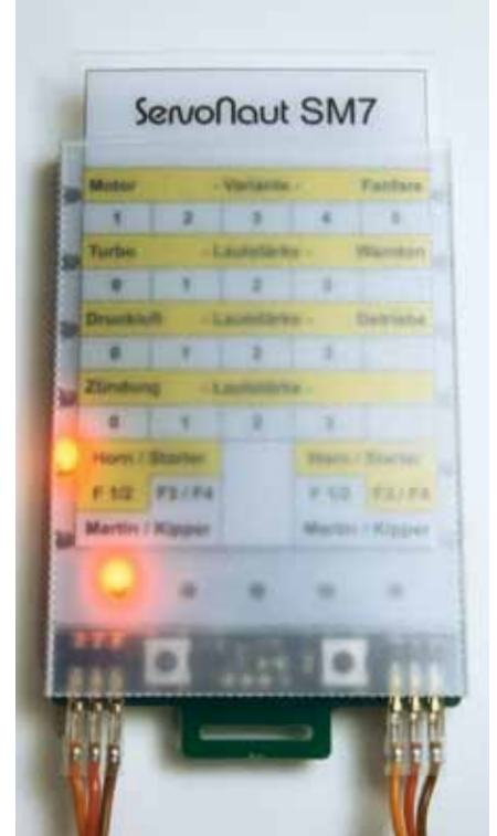
Die im Text beschriebene Einstellung, die Martinhorn und Kipper-Nebenantrieb über die Schalteingänge F3 und F4 ansteuern lässt
