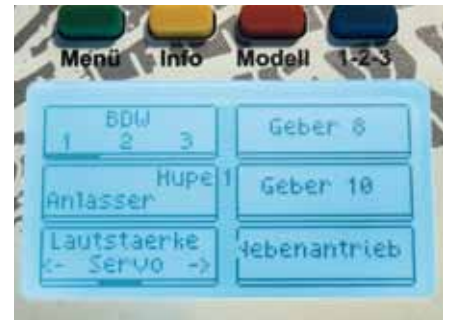
Auf der linken Seite sieht man die Softkeys zur Bedienung des SM7 beim HS12. Mit den Tastern links unten lässt sich die Motorlautstärke vom Sender aus regeln
