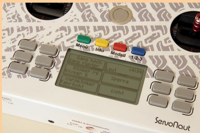
Softkeys sind individuell einstellbar, z. B. Gangschaltung über einen 3-Stufenschalter und Lautstärke über einen Schieber mit Mittelstellung. Der schwarze Balken zeigt die aktuelle Position
