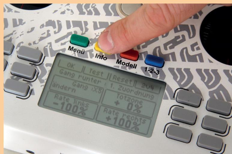
Im Menü „Geber“ wird ein Knüppel oder ein Tastenpaar einem, zwei oder drei Kanälen zugeordnet. Hier ist die erste Zuordnung des Tastenpaares „Gang rauf“ und „Gang runter“ auf den Kanal „Gang X5“. Über die gelbe Taste kann man direkt testen, ob alles passt
