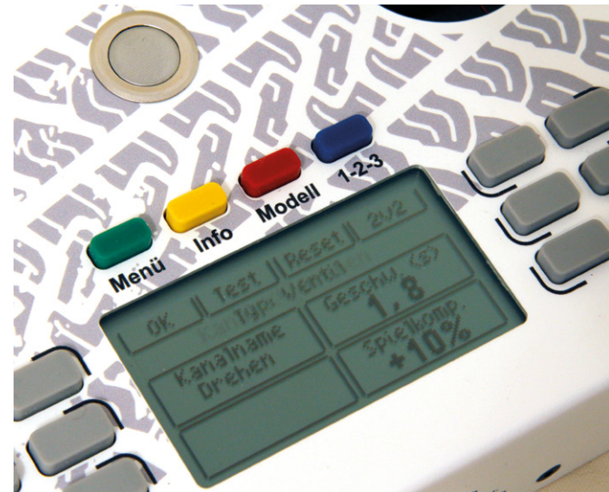
Die Spielkompensation gleicht den Totbereich eines Servos aus, während die Stellgeschwindigkeit für sanfte Bewegungen sorgt.
