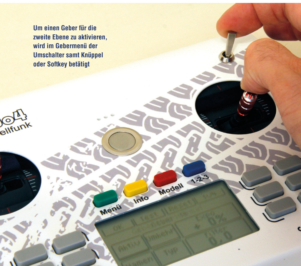
Dank Multiswitch-Unterstützung kann für jede Lichtfunktion ein einzelner Taster verwendet werden
