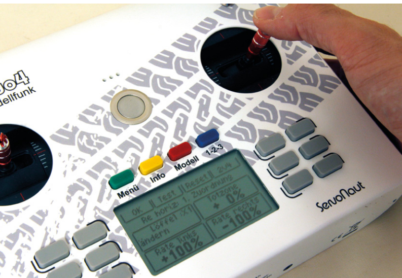
Einfaches Mischerkonzept: Der rechte Knüppel wirkt in der ersten Zuordnung zu 100% seines Ausschlags auf das Ventil des Löffels ...
