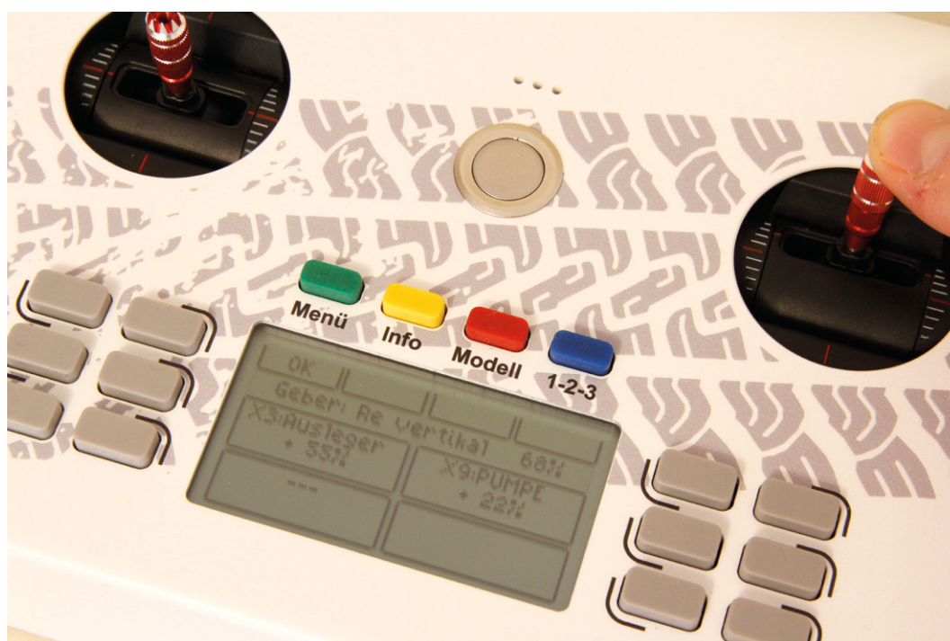
Das Menü „Geberinfo“ zeigt an, auf welche Kanäle ein betätigter Geber wirkt und wie stark
