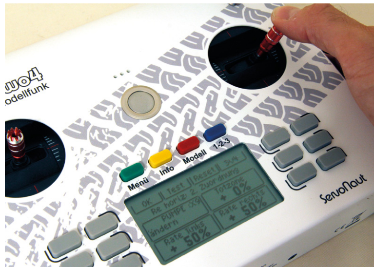
... und in der zweiten Zuordnung zu 50% auf die Pumpe, hierbei aber immer im Rechtslauf (positives Vorzeichen)
