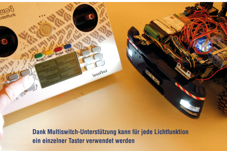
Im Gebermenü werden den Softkeys die Unterkanäle des Multiswitches zugeordnet. Die Rundumleuchte meines TGX wird über Schalter 2 (Sch2) des Beier-Moduls geschaltet
