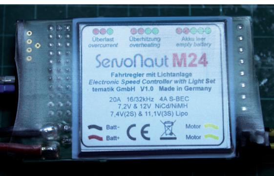
**Die Rückseite des M24 gibt Aufschluss über die Bedeutung der LED. Außerdem ist hinter der Kunststoffummantelung der Kühlkörper untergebracht**
