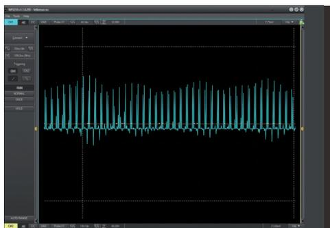
**Wird die Anfahrhilfe genutzt, sieht man hier die der Motortaktung überlagerte Frequenz, in der die Einschaltsequenzen deutlich dichter liegen. Dies erzeugt das benötigte Drehmoment**
