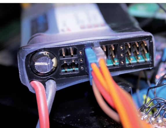
Neben den beiden benötigten Empfängerkanälen sind noch zwei Multibus-Anschlüsse zu sehen. Die rechten Buchsen dienen zum Anschluss des Servos für die Sattelplatte sowie der Soundanlage und des IR-Anhängemoduls von Servonaut
