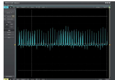
**Bei abgeschalteter Anfahrhilfe ist die motorschonende gleichmäßige Taktung zu erkennen**
