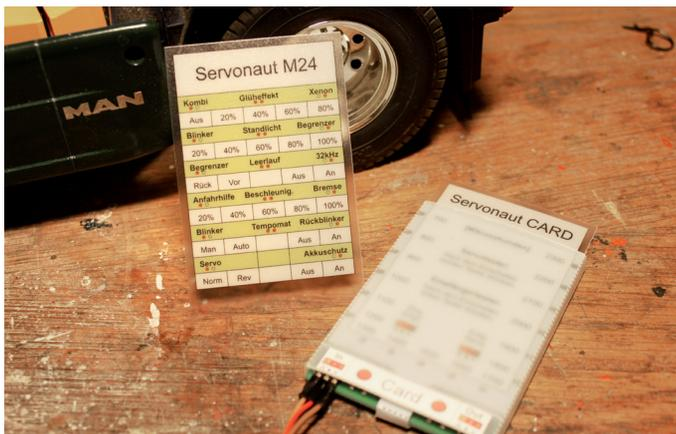
Mit der Servonaut CARD wird der Regler konfiguriert. Dabei wird einfach die dem Regler beiliegende Karte in den Programmieradapter geschoben, um die Bedeutung der LEDs zu definieren
