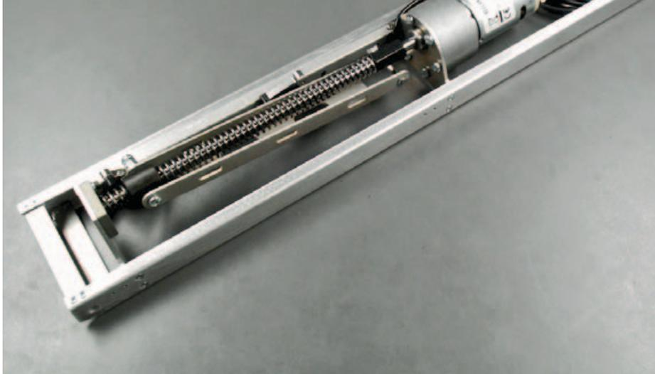
Der vormontierte Hilfsrahmen mit den Endschaltern
