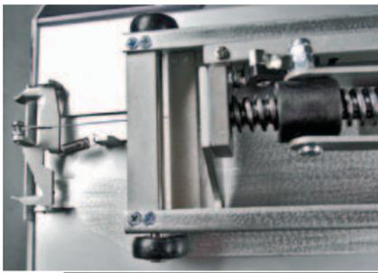
◀ Das Verriegelungssystem im Detail; oberhalb der Spindel sitzt die Inbusschraube, wo das Stahlseil des Mechanismus befestigt wird
