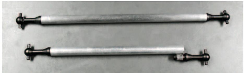
Oben die Welle für die Tamiya-Fahrzeuge, unten die gekürzte Welle für den Allradantrieb
